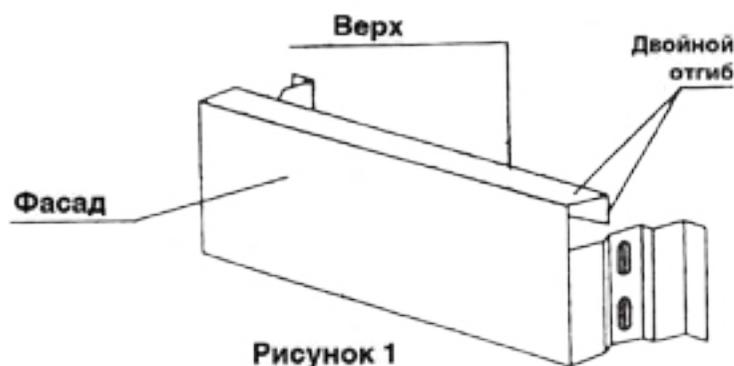
**Крышка шкафа**. На внутренней поверхности крышки с трех сторон располагаются 4 детали с восемью продолговатыми отверстиями для крепления к боковым и задним стенкам (рис. 2).
