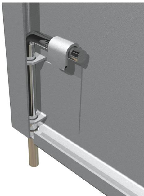
13. Вставить дверь осью в отверстие втулки дна.
