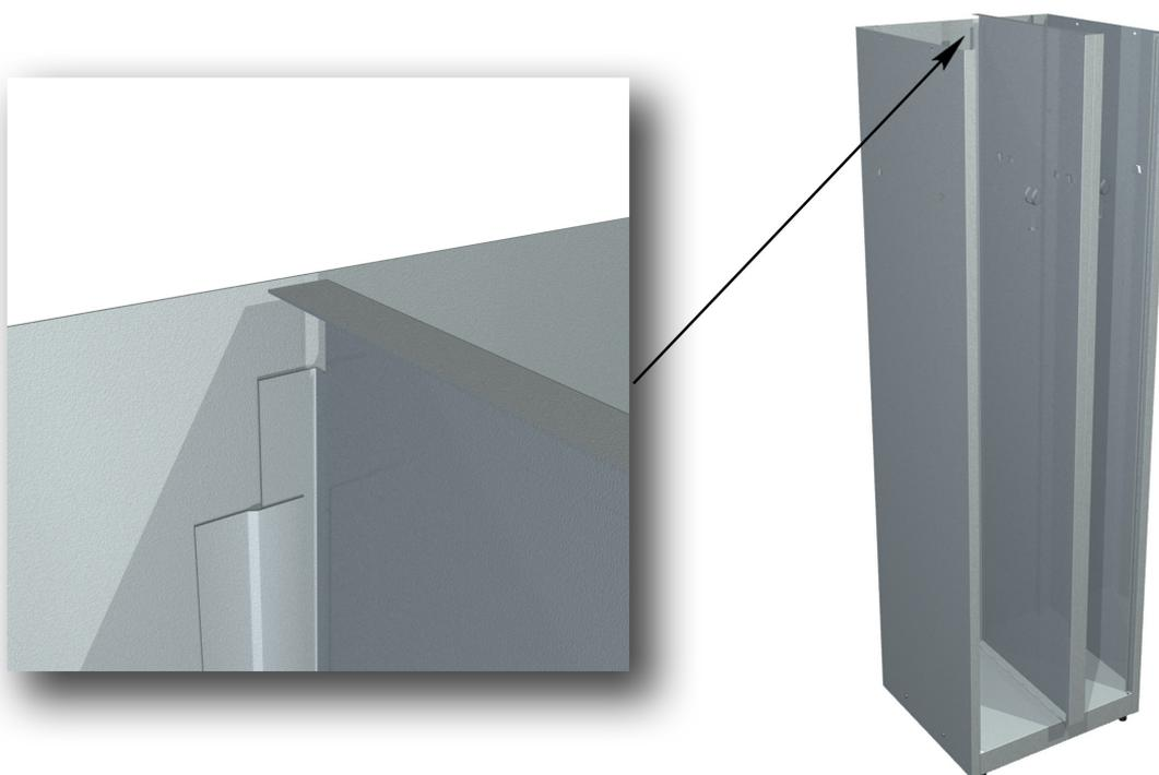
7. Прикрепить перегородку к дну с помощью двух саморезов с шайбами.
