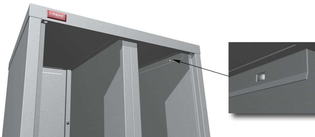
9. Установить полки , надев их на соответствующие крючки на боковинах и перегородке.
