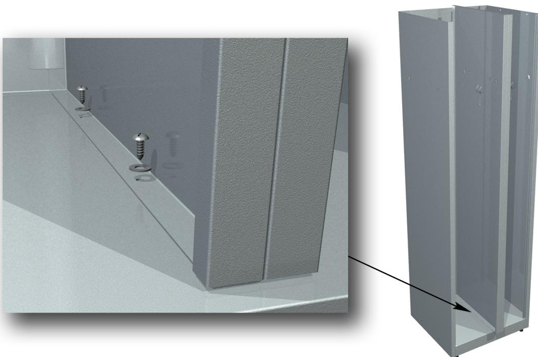
8. Установить крышу . При установке крыши боковые и задние стенки должны располагаться между внутренними боковыми поверхностями крыши и угловыми профилями. Крышу опустить вниз до защелкивания замков боковых стенок в отверстиях угловых профилей крыши.
