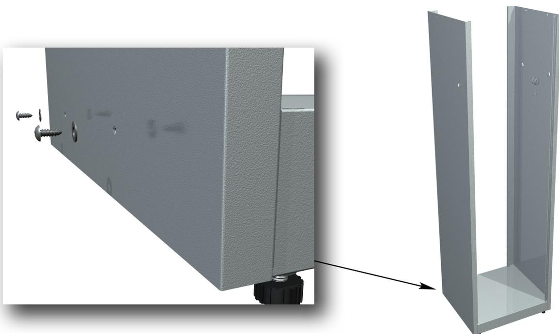
5. Установить заднюю стенку, соединив ее с боковыми стенками с помощью шести саморезов с шайбами. Отбортовка на узкой стороне задней стенки должна располагаться снизу.
