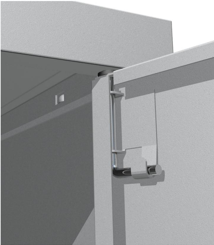
15. Для установки замка снять гайку и шайбу крепления корпуса. Вставить корпус замка в соответствующее отверстие двери и зафиксировать его с помощью гайки с шайбой.
