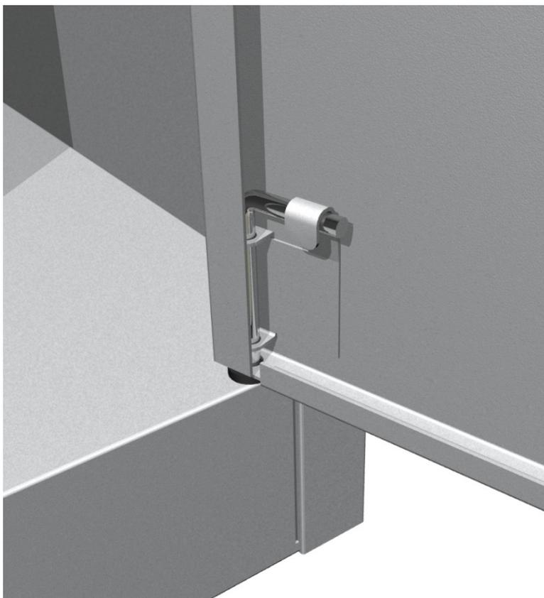
14. Совместить отверстия в верхней части двери с отверстием втулки крыши, вставить ось и зафиксировать ее, загнув лепесток кронштейна.
